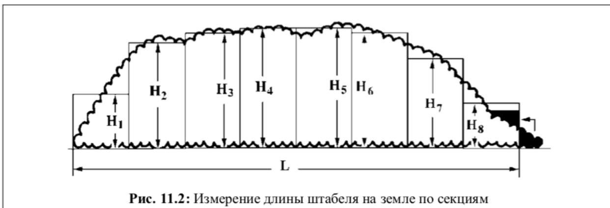
Рис. 11.2: Измерение длины штабеля на земле по секциям
